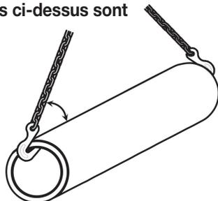
4. Quand la charge ne repose **PAS ENTIÈREMENT** au fond du crochet, la charge appliquée sur chaque crochet pipeline ne peut pas dépasser 2 tonnes.
